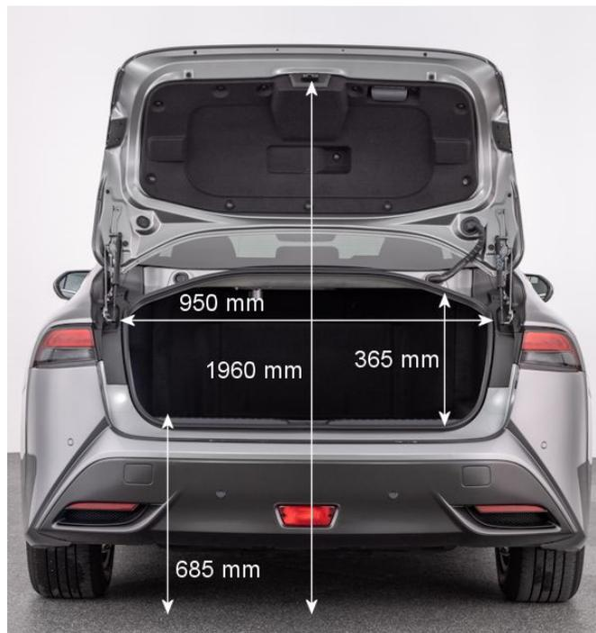
Aufgrund der kleinen Kofferraumöffnung lässt sich der Mirai schwerlich be- und entladen.
