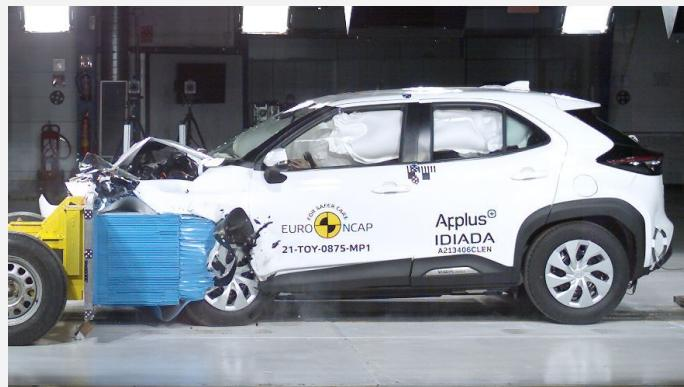
Der Toyota Yaris Cross im frontalen Offsetcrash gegen die rollende Barriere mit Deformationselement (Foto: Euro NCAP)
