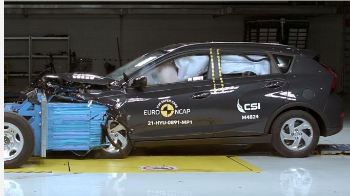
Der Hyundai BAYON im frontalen Offsetcrash gegen die rollende Barriere mit Deformationselement (Foto: Euro NCAP)
