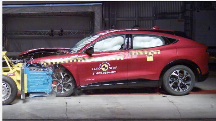
Der Ford Mustang Mach-E im frontalen Offsetcrash gegen die rollende Barriere mit Deformationselement (Foto: Euro NCAP)
