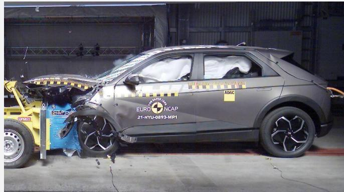
Der Hyundai IONIQ 5 im frontalen Offsetcrash gegen die rollende Barriere mit Deformationselement (Foto: Euro NCAP)
