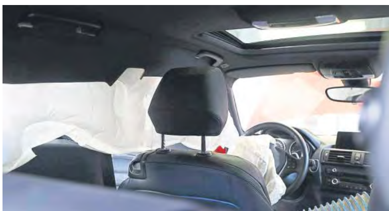
Im Recycling- und Demontagezentrum (RDZ) werden die pyrotechnischen Komponenten wie Airbags vor dem Ausbau per Knopfdruck ausgelöst.
