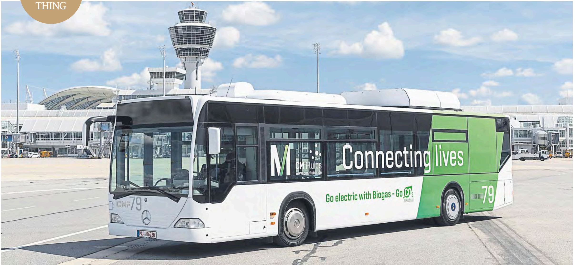
Klimaneutraler Passagiertransport: Ein auf den Betrieb mit flüssigem Biomethan umgerüsteter Passagierbus am Flughafen München. Der Dieselmotor wurde durch einen Gasmotor ersetzt, der einen Generator antreibt, um die elektrische Antriebsachse mit Energie zu versorgen – ein innovatives und zudem wirtschaftliches Antriebskonzept. Foto: Flughafen München GmbH
