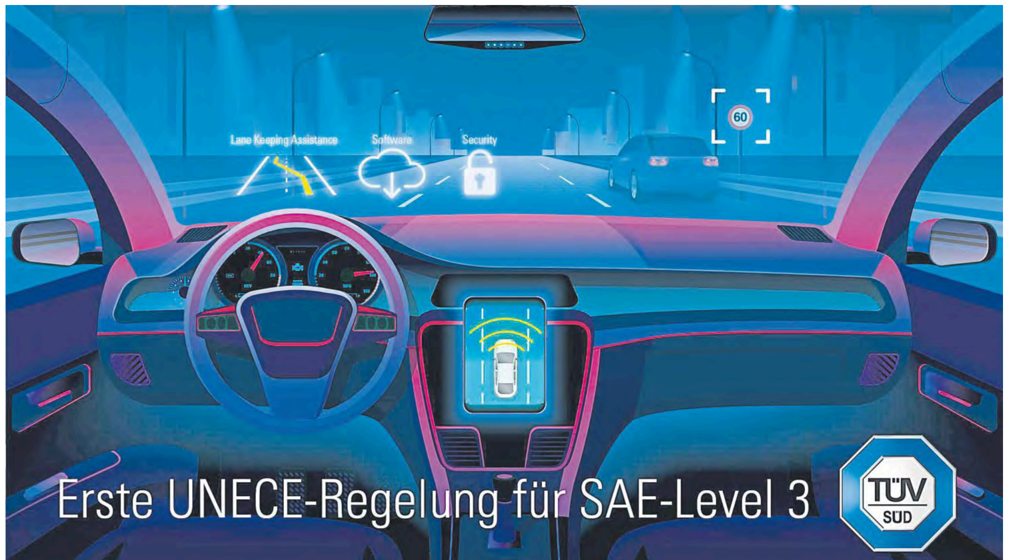
Ein starkes Signal für automatisiertes Fahren: Die erste UNECE-Regelung ermöglicht erstmals den Einsatz von automatisierten Fahrfunktionen nach SAE-Level 3. Damit können zum Beispiel automatische Spurhaltesysteme bis zu einer Geschwindigkeit von 60 km/h genutzt werden. Der Fahrer muss die Hände dabei nicht mehr am Lenkrad halten oder die Aufmerksamkeit anderweitig beweisen. Foto: TÜV SÜD
