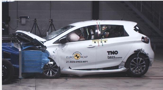
Der Renault Zoe im frontalen Offsetcrash gegen die rollende Barriere mit Deformationselement (Foto: Euro NCAP)
