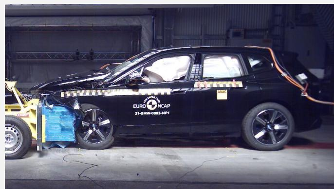
Der BMW iX im frontalen Offsetcrash gegen die rollende Barriere mit Deformationselement (Foto: Euro NCAP)
