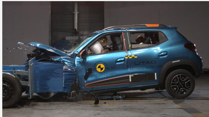
Der Dacia Spring electric im frontalen Offsetcrash gegen die rollende Barriere mit Deformationselement (Foto: Euro NCAP)
