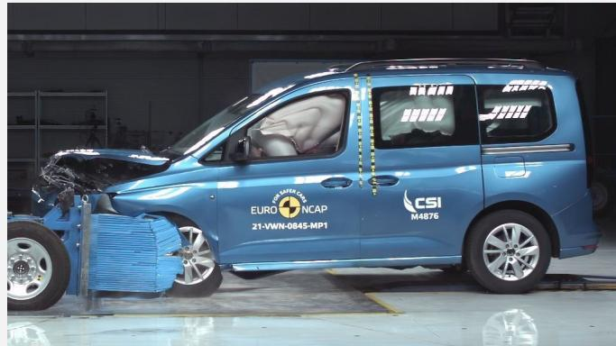
Der VW Caddy im frontalen Offsetcrash gegen die rollende Barriere mit Deformationselement (Foto: Euro NCAP)
