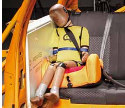
ADAC Crashversuch: Dummy mit Sitzerhöher bei einem Seitencrash: Kopf und Körper des Dummys schlagen an die Fahrzeugseitenwand.
