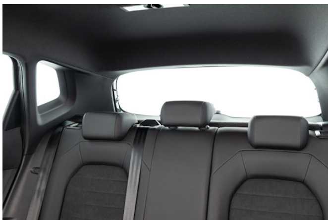
Breite Dachstützen schränken die Sicht nach schräg hinten erheblich ein.
