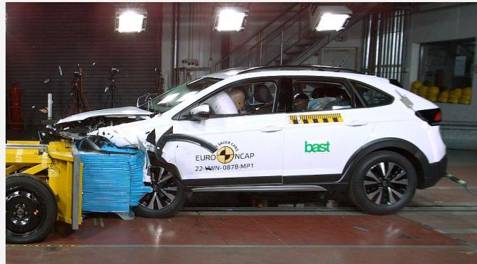
Der VW Taigo im frontalen Offsetcrash gegen die rollende Barriere mit Deformationselement (Foto: Euro NCAP)
