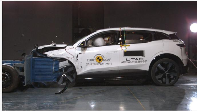
Der Renault Mégane E-Tech im frontalen Offsetcrash gegen die rollende Barriere mit Deformationselement (Foto: Euro NCAP)
