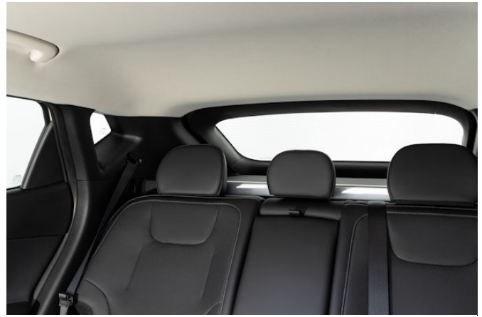
Die sehr breiten Dachsäulen und die nicht versenkbaren Kopfstützen schränken die Sicht nach hinten erheblich ein.
