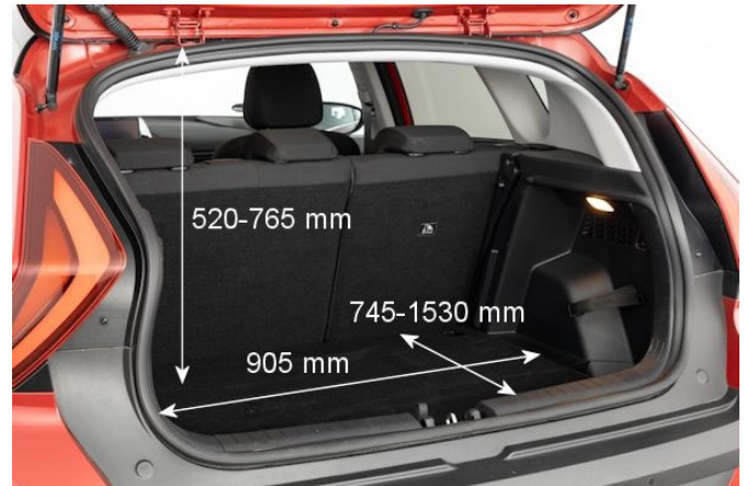
Die 48-V-Batterie unter dem Ladeboden reduziert die Kofferraumgröße auf akzeptable 275 l Volumen.
