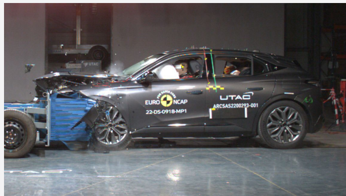
Der DS 4 im frontalen Offsetcrash gegen die rollende Barriere mit Deformationselement (Foto: Euro NCAP)
