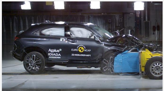
Der Honda HR-V im frontalen Offsetcrash gegen die rollende Barriere mit Deformationselement (Foto: Euro NCAP)
