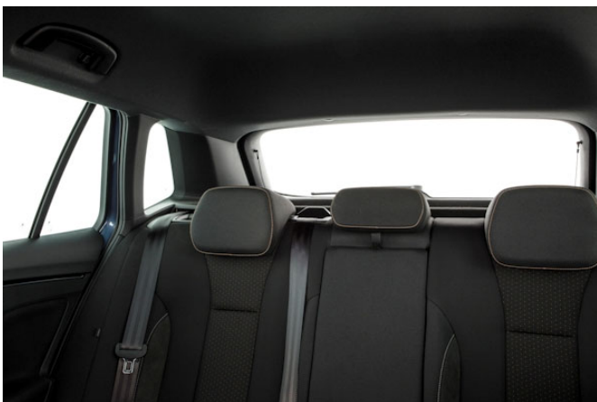
Die recht breiten Dachsäulen schränken die Sicht nach hinten ein.
