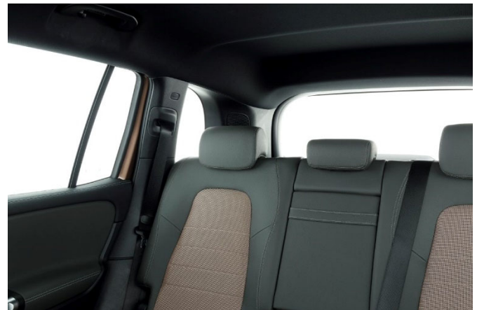
Breite Dachsäulen und die nur teilweise versenkbaren Fondkopfstützen schränken die Sicht nach hinten ein.
