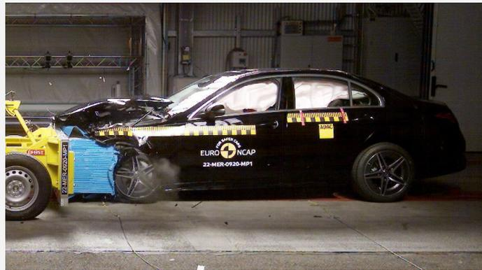
Die Mercedes-Benz C-Klasse im frontalen Offsetcrash gegen die rollende Barriere mit Deformationselement (Foto: Euro NCAP)
