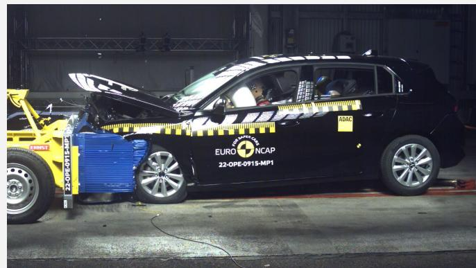
Der Opel Astra im frontalen Offsetcrash gegen die rollende Barriere mit Deformationselement (Foto: Euro NCAP)
