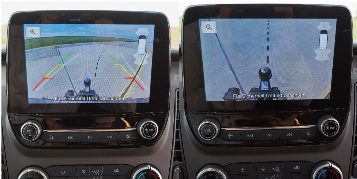
In das Bild der Rückfahrkamera wird die aktuelle Fahrspurbreite eingeblendet – oder man zoomt auf die Anhängerkupplung. (Quelle: ADAC/Uwe Rattay)
