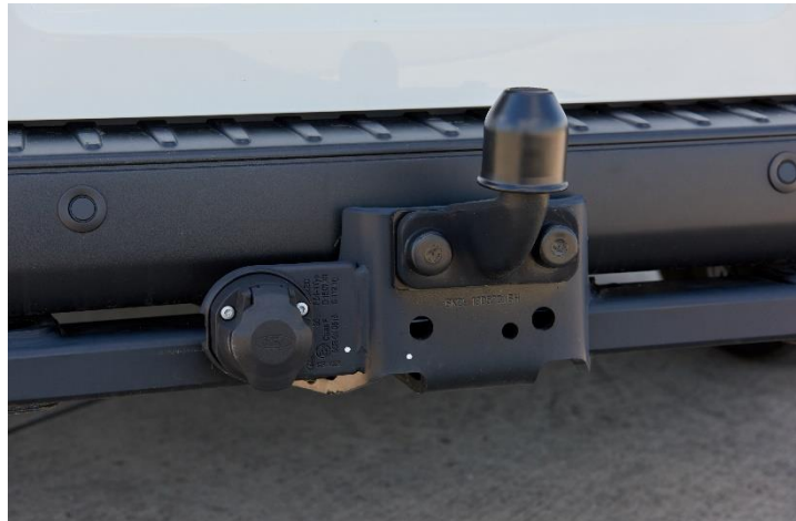
Die serienmäßige Anhängerkupplung ist stabil ausgeführt und sogar höhenverstellbar. (Quelle: ADAC/Uwe Rattay)
