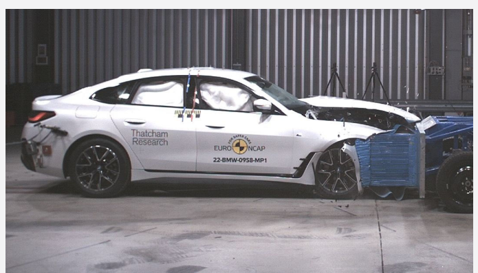
Der BMW i4 im frontalen Offsetcrash gegen die gleichschnell entgegenrollende Barriere mit Deformationselement (Foto: Euro NCAP)
