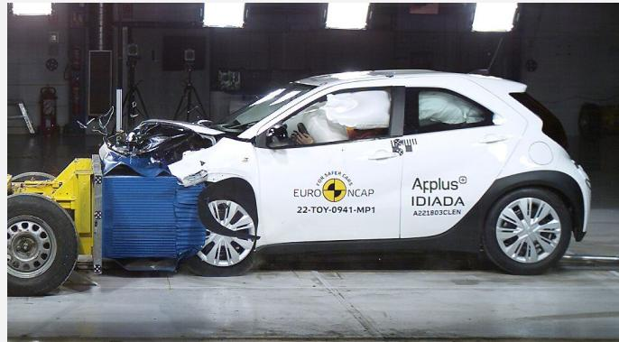
Der Toyota Aygo X im frontalen Offsetcrash gegen die gleichschnell entgegenrollende Barriere mit Deformationselement (Foto: Euro NCAP)
