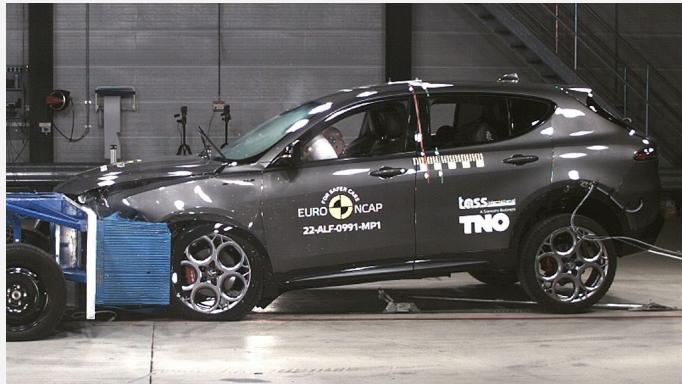
Der Alfa Romeo Tonale im frontalen Offsetcrash gegen die gleichschnell entgegenrollende Barriere mit Deformationselement (Foto: Euro NCAP)
