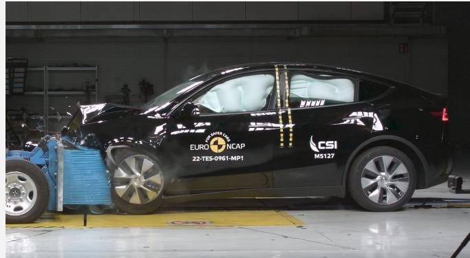
Der Tesla Model Y im frontalen Offsetcrash gegen die gleichschnell und versetzt entgegenrollende Barriere mit Deformationselement (Foto: Euro NCAP)
