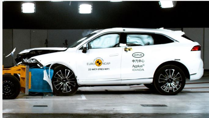
Der WEY Coffee 01 im frontalen Offsetcrash gegen die gleichschnell entgegenrollende Barriere mit Deformationselement (Foto: Euro NCAP)
