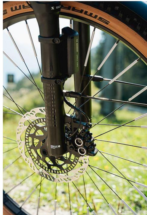
Bild 1: Das ABS verrät sich durch die Impulsringe an den Bremscheiben. Bild: ADAC/ V. Schwenk
