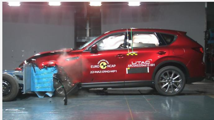
Der Mazda CX-6o im frontalen Offsetcrash gegen die gleichschnell und versetzt entgegenrollende Barriere mit Deformationselement (Foto: Euro NCAP)
