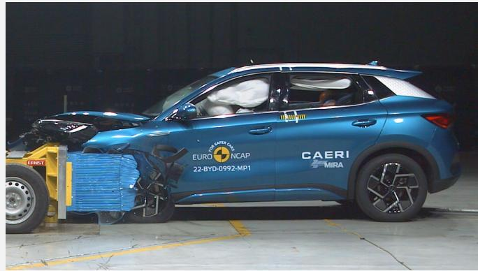
Der BYD Atto 3 im frontalen Offsetcrash gegen die gleichschnell und versetzt entgegenrollende Barriere mit Deformationselement (Foto: Euro NCAP)
