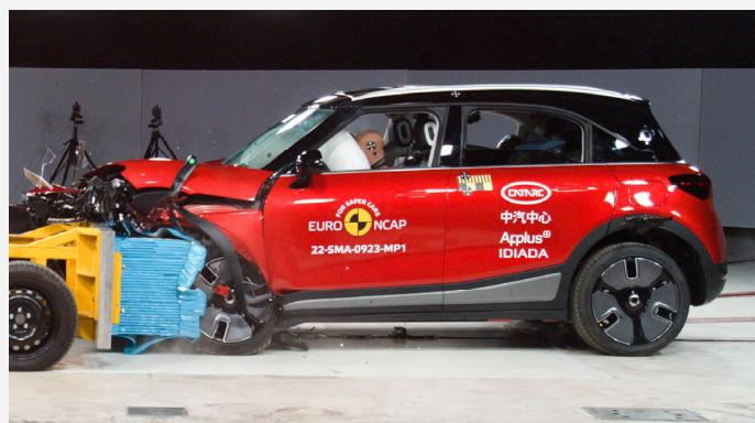
Der smart #1 im frontalen Offsetcrash gegen die gleichschnell und versetzt entgegenrollende Barriere mit Deformationselement (Foto: Euro NCAP)
