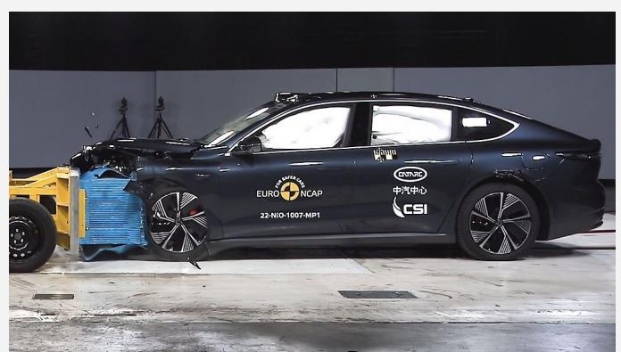
Der NIO eT7 im frontalen Offsetcrash gegen die gleichschnell und versetzt entgegenrollende Barriere mit Deformationselement (Foto: Euro NCAP)
