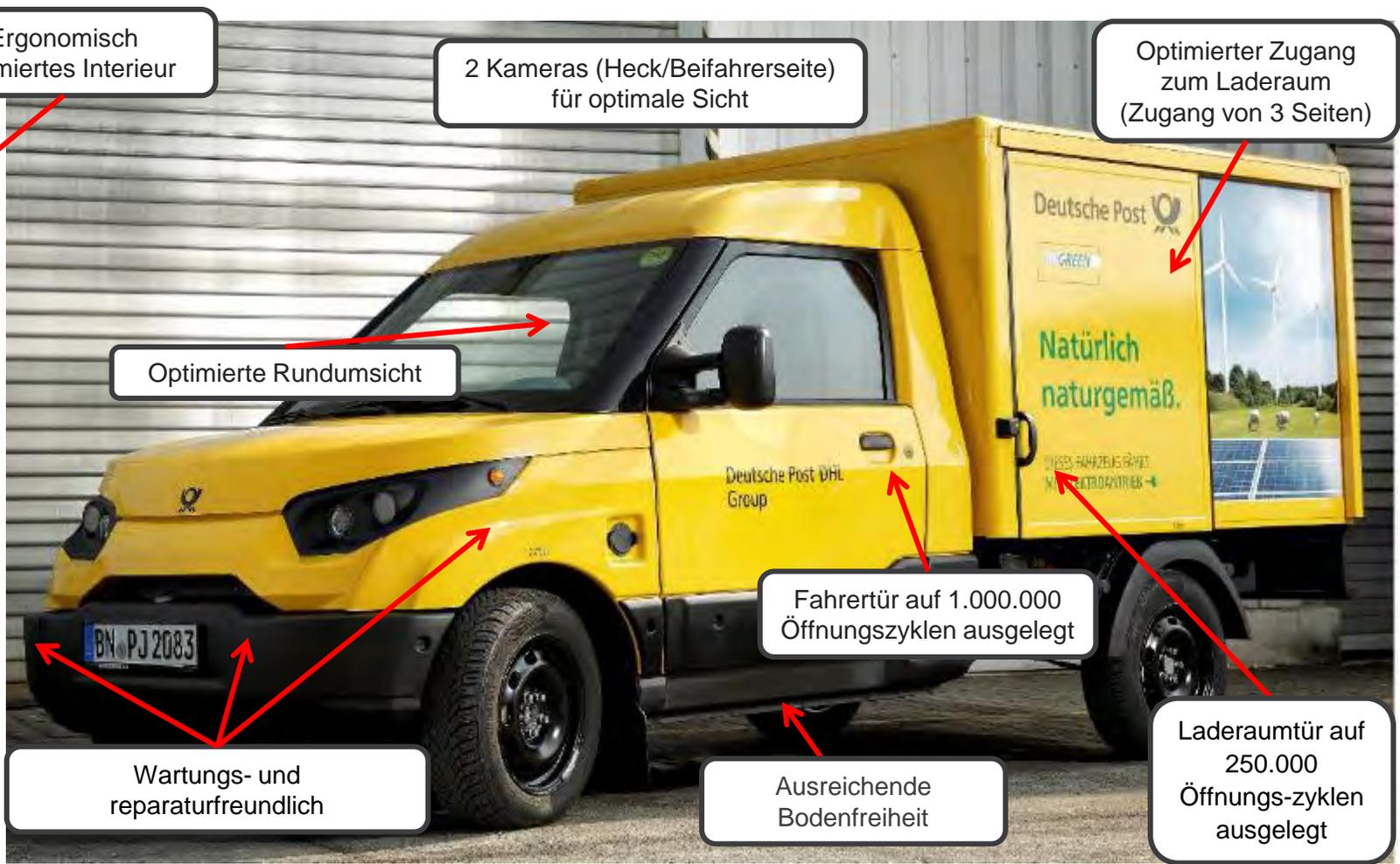
2 Kameras (Heck/Beifahrerseite) für optimale Sicht
