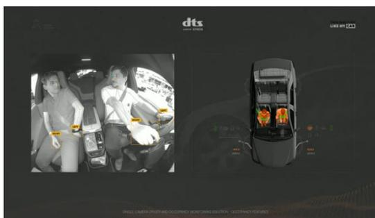
So detektiert das DTS-System die Fahrzeugpassagiere
