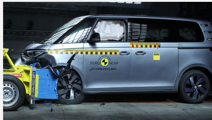
Der VW ID.Buzz im frontalen Offsetcrash gegen die gleichschnell und versetzt entgegenrollende Barriere mit Deformationselement (Foto: Euro NCAP)
