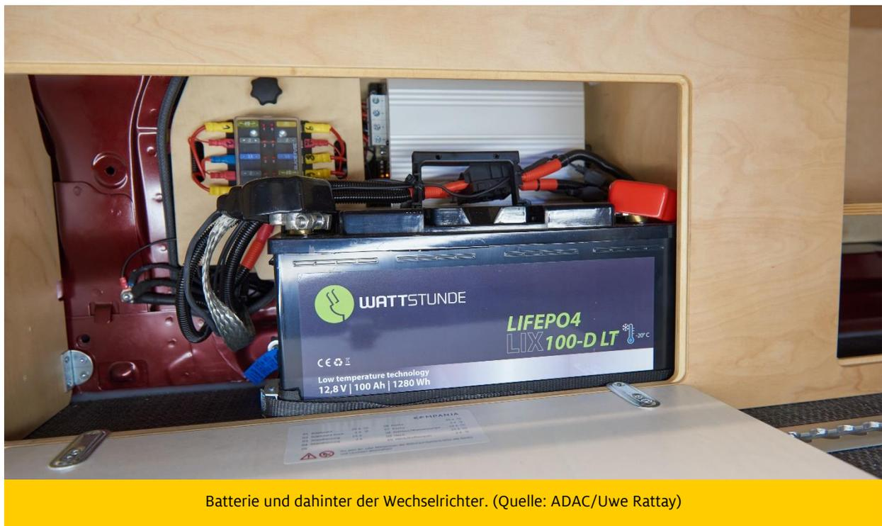
Batterie und dahinter der Wechselrichter. (Quelle: ADAC/Uwe Rattay)
