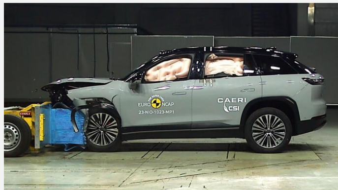
Der NIO EL7 im frontalen Offsetcrash gegen die gleichschnell und versetzt entgegenrollende Barriere mit Deformationselement (Foto: Euro NCAP)
