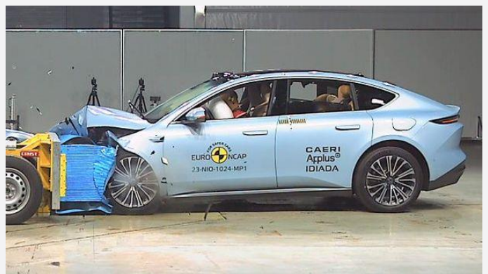
Der NIO ET5 im frontalen Offsetcrash gegen die gleichschnell und versetzt entgegenrollende Barriere mit Deformationselement (Foto: Euro NCAP)
