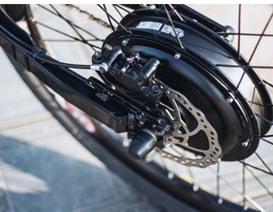
Ein Hinterrad-Nabenmotor eignet sich für sportliche Pedelecs.
