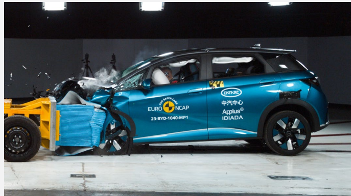
Der BYD DOLPHIN im frontalen Offsetcrash gegen die gleichschnell und versetzt entgegenrollende Barriere mit Deformationselement (Foto: Euro NCAP)
