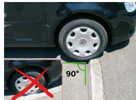
Wenn möglich, im rechten Winkel und langsam über den Randstein fahren.
