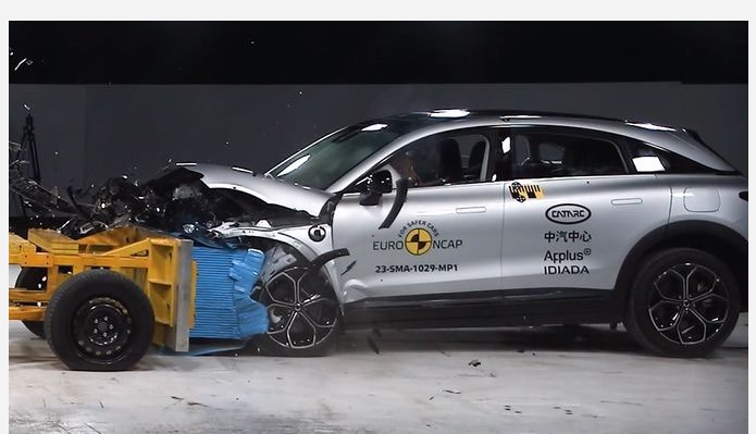
Der smart #3 im frontalen Offsetcrash gegen die gleichschnell und versetzt entgegenrollende Barriere mit Deformationselement (Foto: Euro NCAP)
