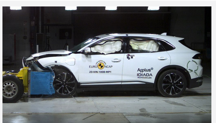
Der VinFast VF8 im frontalen Offsetcrash gegen die gleichschnell und versetzt entgegenrollende Barriere mit Deformationselement (Foto: Euro NCAP)
