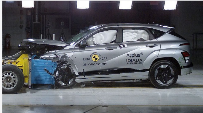
Der Hyundai KONA im frontalen Offsetcrash gegen die gleichschnell und versetzt entgegenrollende Barriere mit Deformationselement (Foto: Euro NCAP)
