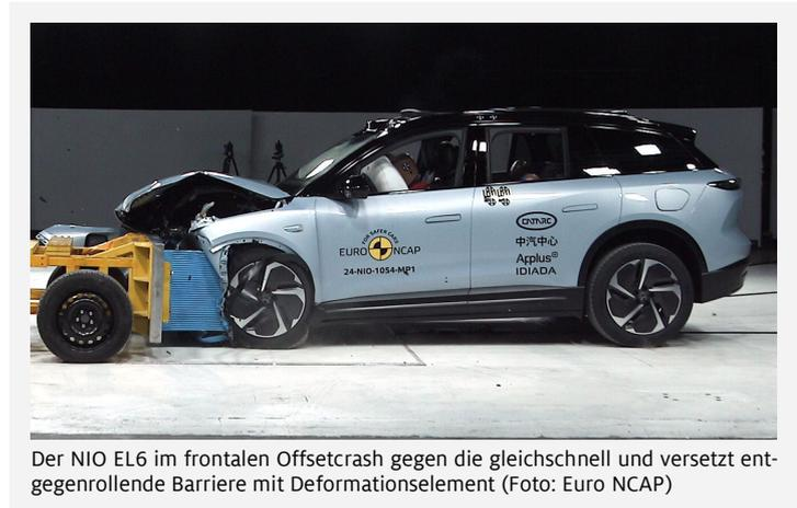
Der NIO EL6 im frontalen Offsetcrash gegen die gleichschnell und versetzt entgegenrollende Barriere mit Deformationselement (Foto: Euro NCAP)
