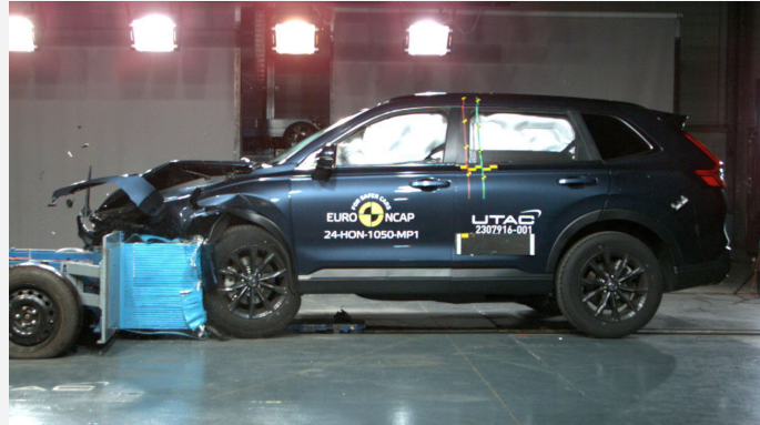
Der Honda CR-V im frontalen Offsetcrash gegen die gleichschnell und versetzt entgegenrollende Barriere mit Deformationselement (Foto: Euro NCAP)
