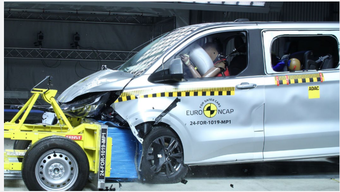
Der Ford Tourneo Custom im frontalen Offsetcrash gegen die gleichschnell und versetzt entgegenrollende Barriere mit Deformationselement (Foto: Euro NCAP)
