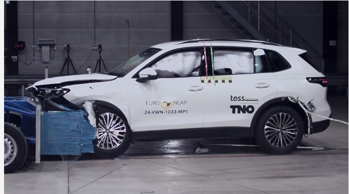
Der VW Tiguan im frontalen Offsetcrash gegen die gleichschnell und versetzt entgegenrollende Barriere mit Deformationselement (Foto: Euro NCAP)
