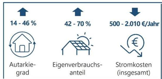
Wichtige Parameter: Haushaltsverbrauch: ~ 3.100 kWh/Jahr; PV-Anlage: 7 kWp; Strommarktpreise 2021/ 2022; PV-Einspeisevergütung: 8 ct/kWh
